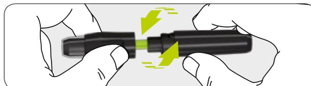
2. Praktischer Bajonetverschluss mit automatischer Stoppfunktion für einfachen Lanzettenwechsel.
