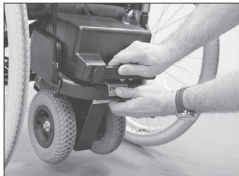
5. Entfernen Sie den V-Drive, indem Sie während des Herausziehens des V-Drive in rückwärtiger Richtung aus den Halterungen am Klettverschlussriemen ziehen.
