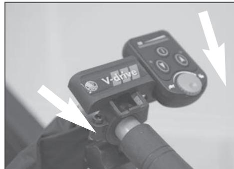
Sie das Einlegegummi). Ziehen Sie mit dem Inbusschlüssel die Schrauben der Halteklammern wieder handfest an. Danach ziehen Sie den Controller von vorne nach hinten über die Halteklammer des Gasgriffs.
