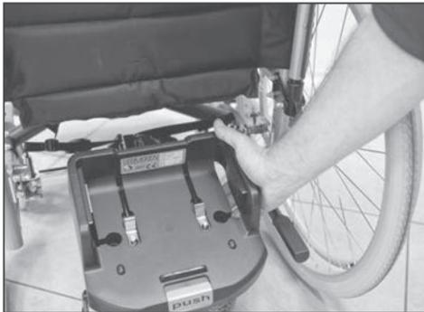
knopf an der Stange und stellen Sie diese auf die korrekte Länge. Ziehen Sie die Drehknöpfe an der Stange und der Vorderseite des V-Drive fest. Positionieren Sie die beiden Enden der Stange hinter den Halterungen und drücken Sie dann den V-Drive nach vorne, bis er einrastet.
