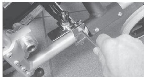
rahmen des Rollstuhls. Schließen Sie den Klettverschluss. Stellen Sie sicher, dass die Schrauben fest angezogen sind und die Halterungen nicht am Rahmen drehen.
