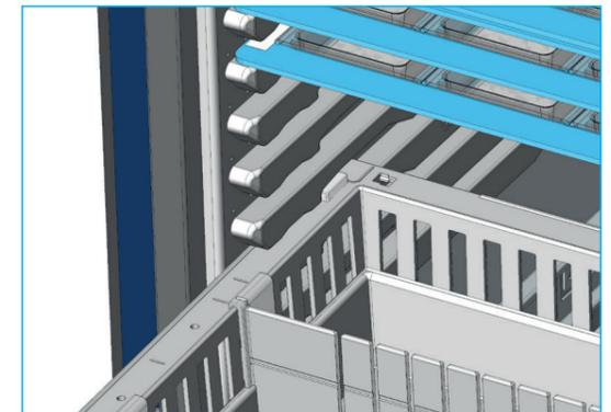
Profilwände ermöglichen eine flexiblere Nutzung des Wagens
