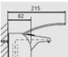
...ELS .../... mit langem Armhebel (etwa 170 mm sichtbare Hebellänge), für 500 ml Flaschen
