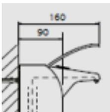
...T.../... mit kurzem Armhebel (etwa 100 mm sichtbare Hebellänge), für 1000 ml Flaschen
