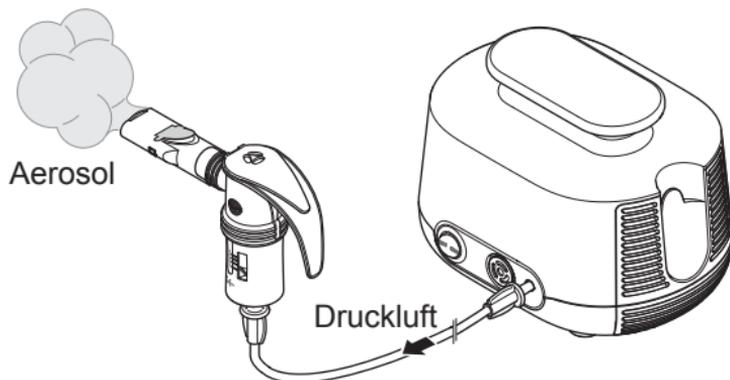
Der Kompressor versorgt den Vernebler mit Druckluft.
