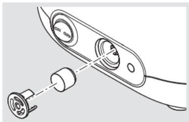
Sostituzione del filtro dell'aria:
