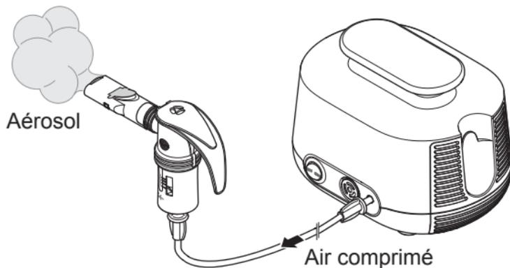
Le compresseur alimente le nébuliseur en air comprimé.
