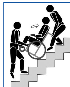
Figure 13 Utiliser les escaliers
